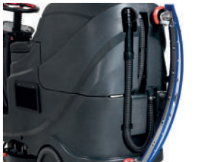
Soporte en la parte trasera para colgar la boquilla y poder pasar por zonas estrechas
