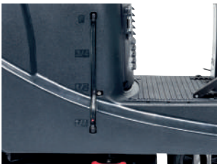
Indicador de nivel de solución de agua con volumen visible en el depósito
